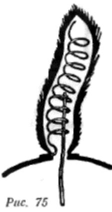
**Подвижной слоновый хобот** (рис. 72) сделан из последовательно уменьшающихся твердых колец (деревянных или картонных). Внутри пропущена нитка, прикрепленная к последнему кольцу. Кольца с обеих сторон срезаны по наклону. Сверху хобот обтягивается трикотажем. Когда нитку натягивают, кольца прислоняются одно к другому, и хобот закручивается вверх.
